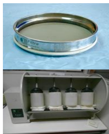
Foto 1: Equipo molturación Filtra y tipo tamiz utilizado UNE 7050-3
