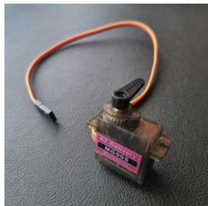
**FIGURA 25: SERVOMOTOR MG90S**
