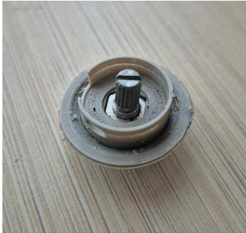
**FIGURA 26: POTENCIÓMETRO CON SU SOPORTE**
