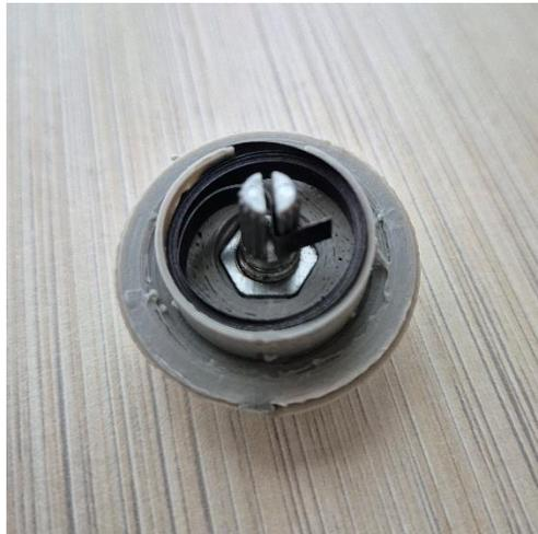
**FIGURA 27: POTENCIÓMETRO CON EL MUELLE**
