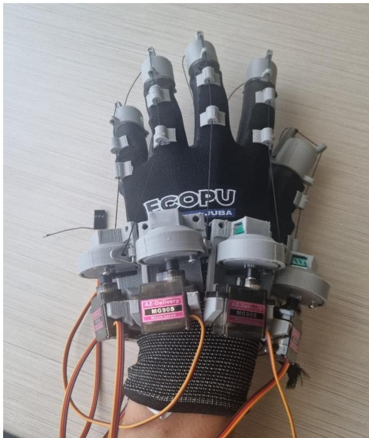
**FIGURA 33: PARTE MECÁNICA DEL GUANTE**
