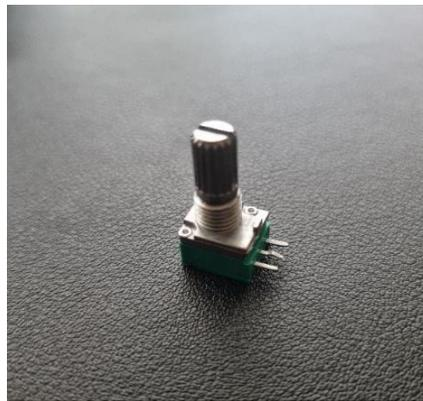
**FIGURA 24: POTENCIÓMETRO 10K OHMS**
