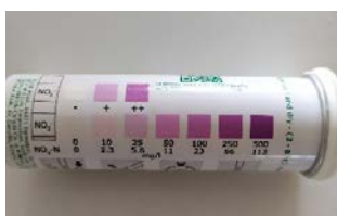
Figura 3. Tiras reactivas de nitratos con escala de color y su equivalente en \text{N-NO}_3^- .
