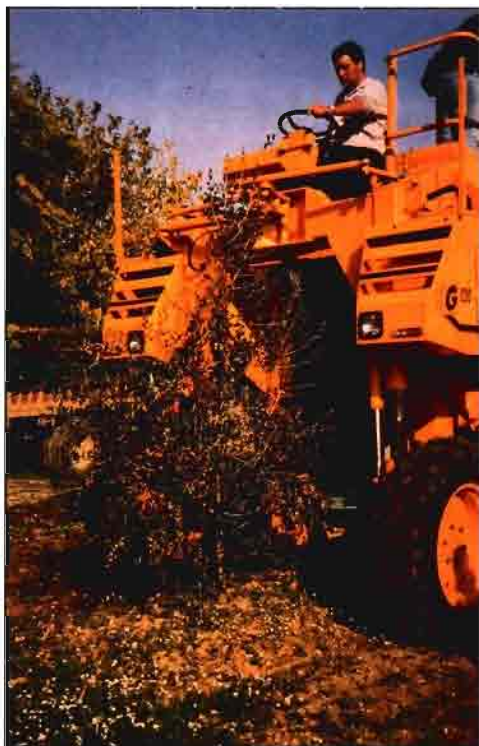
Vendimiadora Gregoire 120 durante la maniobra de aproximación a uno de los olivos a recolectar.
