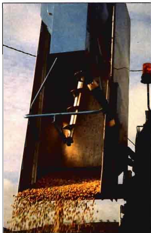
Descarga de la cosecha almacenada en una de las tolvas de la vendimiadora.
