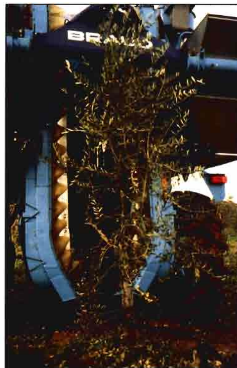
Vista posterior de la vendimiadora Braud 2720, una vez efectuada la recolección de un olivo.
