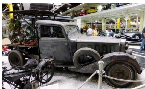
Figura 2. Maybach convertido en aserradero expuesto en el Auto & Technikmuseum Sinsheim (Alemania). (Imagen: autoras)
