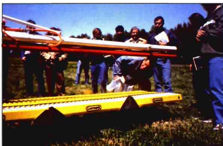
Medida de la uniformidad de distribución horizontal en pulverizadores para cultivos bajos mediante un banco de reparto portátil.
