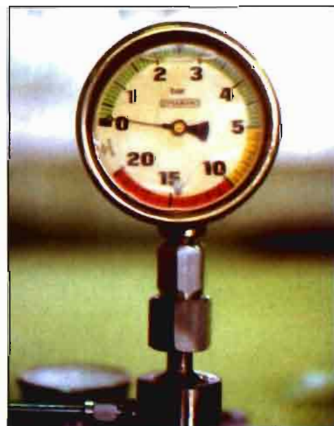
Estudio de la adecuación del manómetro y contraste de sus lecturas.
