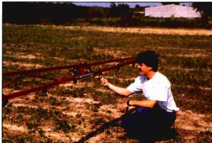
Control de boquillas: posición y caudal unitario.
