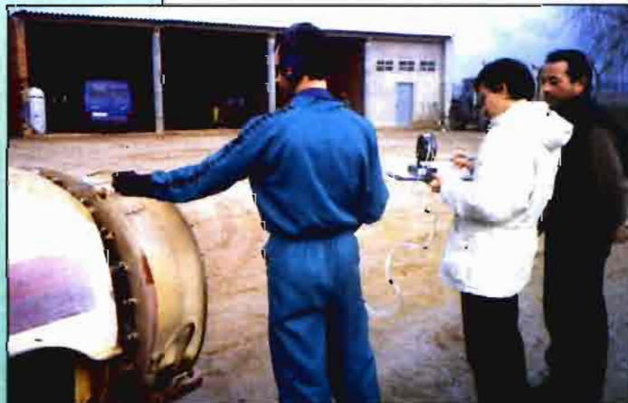
Medida de la velocidad de aire mediante sonda Prandtl en pulverizadores para cultivos arbóreos.
