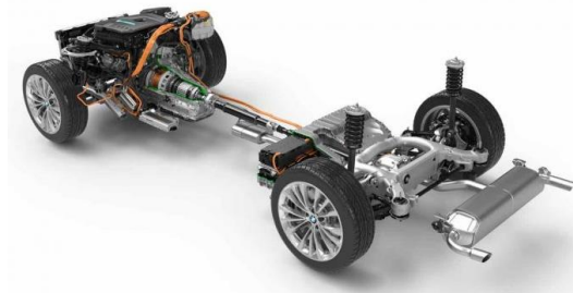
Ilustración 70: Motor híbrido gasolina enchufable. (Fuente: https://noticias.coches.com/consejos/coches-hibridos-tipos/357621 )
