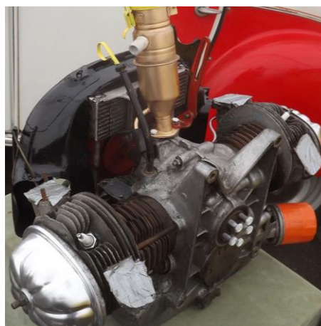
Ilustración 36: Motor bicilíndrico de un Citroën 2CV. (Fuente: https://www.wikiwand.com/es/Motor_bicil%C3%ADndrico )
