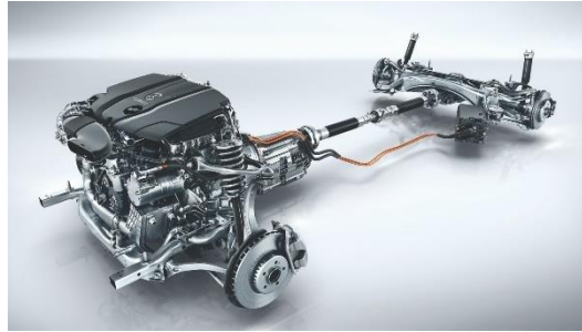
Ilustración 69: Motor híbrido diésel enchufable. (Fuente: https://www.quadis.es/articulos/mercedes-benz-estrena-los-hibridos-enchufables-diesel/7137097 )
