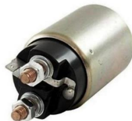
Ilustración 27: Solenoide de arranque. (Fuente: https://zonadelmotor.com/sistema-de-arranque/solenoide-de-arranque/fallas-comunes-del-solenoide-de-arranque/ )
