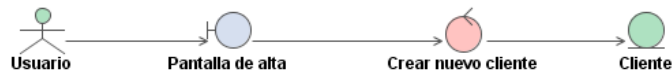
Diagrama de interacción del análisis del caso de uso "Crear nuevo cliente"
