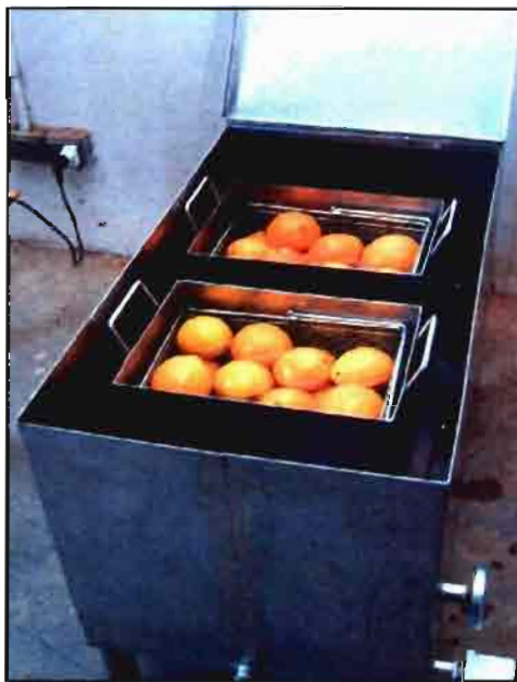
Sistema de baño para ensayos de efectividad a pequeña escala.
