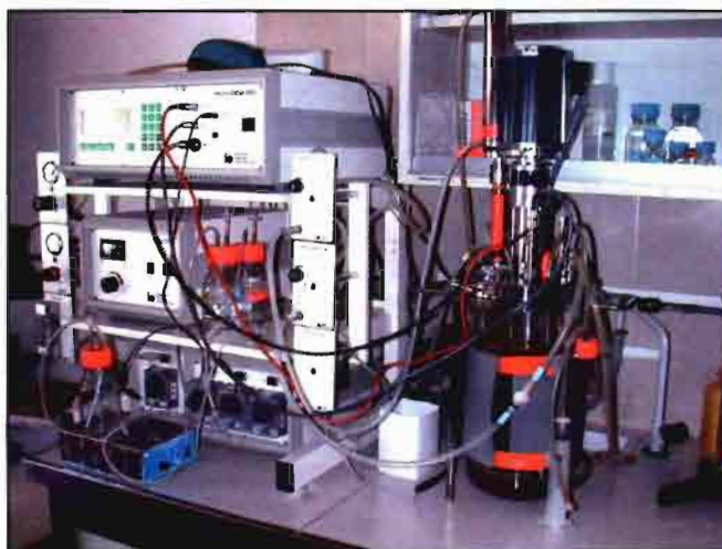
Fermentador de laboratorio en el que se lleva a cabo la optimización de la producción de los diversos agentes de biocontrol estudiados.
