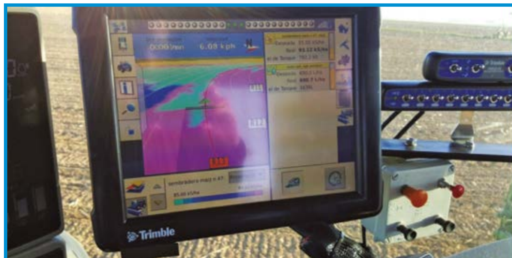
Figura 5: Ejemplo de monitor de tasa variable de aplicación que permite tasas variables de siembra en base a un mapa del campo que muestra diferentes zonas de manejo de acuerdo a la variabilidad espacial de las propiedades del suelo.
