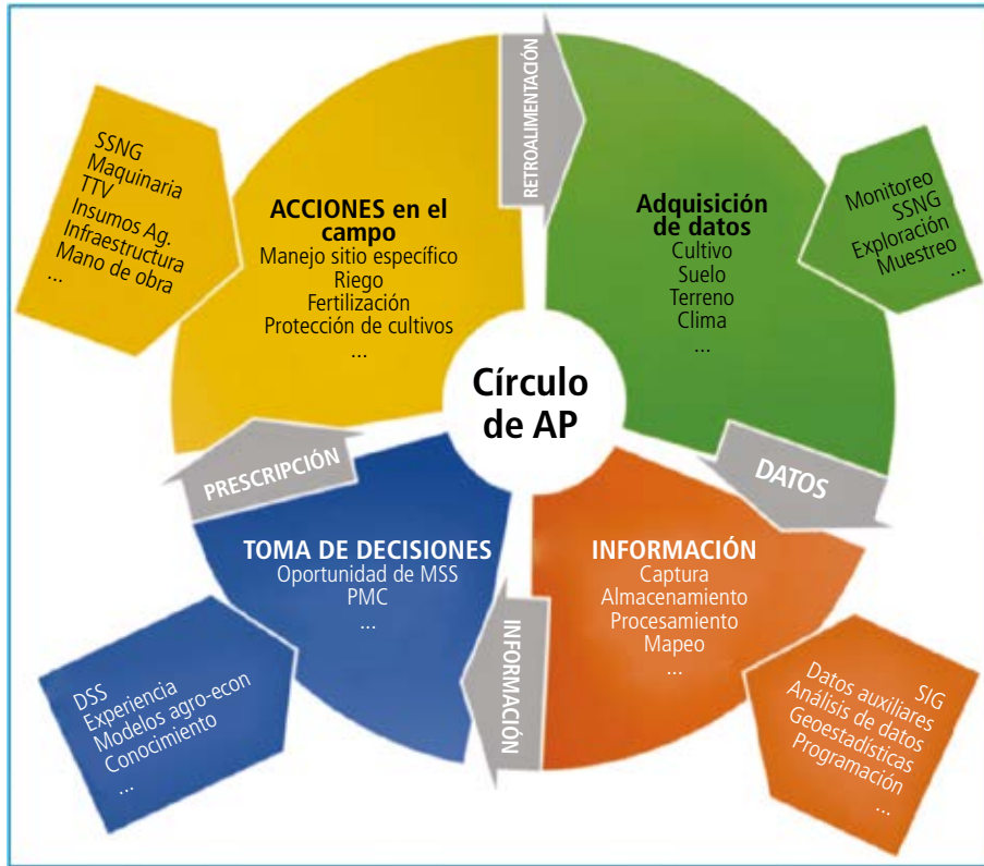
Figura 2 : El ciclo agrícola de prescripción. La AP se puede reducir a 4 etapas. La primera consiste en juntar la mayor cantidad posible de datos sobre el cultivo, suelo, terreno y ambiente en general. El resultado de esta etapa son datos que serán procesados durante la etapa de extracción de la información. Una vez que los datos son convertidos en información es tiempo de tomar decisiones de manejo. El resultado de esta etapa es la prescripción que será implementada en la última etapa. Las flechas alrededor del círculo son los posibles insumos requeridos en cada etapa. Cuando la información y la prescripción se muestran en un mapa y el círculo tarda varios días en completarse; es el caso de lo que se conoce como AP basada en mapas. Cuando la información no es mapeada y el círculo se completa en milisegundos, es el caso de AP basada en sensores en tiempo real.
