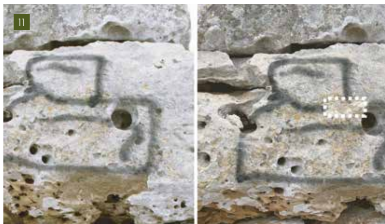
[9] Imatge durant les proves de remoció amb l'emulsió gelificada d'alcohol benzilic. Es pot apreciar que la remoció és insuficient (Fotografia: Francesc Isbert).
