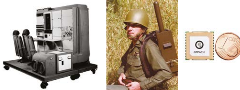
Figura 1: Uno de los primeros receptores de GPS militares utilizado como un modelo general de desarrollo fabricado por Rockwell Collins cerca de 1977 (izquierda, adaptado de GPSWorld). Una unidad de GPS Magnavox mapck de 25x45x15 cm y más de 11 kilos aparece en el primer catálogo de un receptor de GPS a mediados de los 70s (centro, adaptado de GPSWorld). Un receptor completo de GNSS (incluye la antena) lanzado en el 2012. Mide 16x16x6.8 mm y pesa 6 gramos (derecha, adaptado de Globaltop Technology Inc.).
