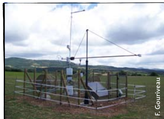
Foto 1. Torre micrometeorològica FLUXPYR a Catalunya per a la mesura en continu dels fluxos de carboni, aigua i energia entre el sòl i l'atmosfera, en una parcel·la agrícola: l'anemòmetre, l'analitzador infraroig de CO 2 i vapor d'aigua, el pluviòmetre i el radiòmetre són alguns dels instruments que utilitza.
