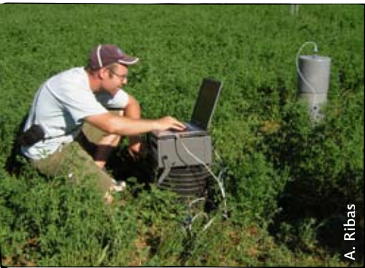
Foto 2. Mesures de les emissions de CO 2 , N 2 O i CH 4 amb un aparell fotoacústic en un camp agrícola amb diferents tractaments de diversitat i grups funcionals vegetals. Les taxes d'emissions s'acceleren després de la irrigació del camp, i quan la temperatura és més elevada.
