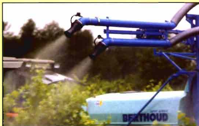
Pulverizador para viñedos dotado de conducciones individuales para cada boquilla que permite conseguir una elevada eficiencia de distribución.
