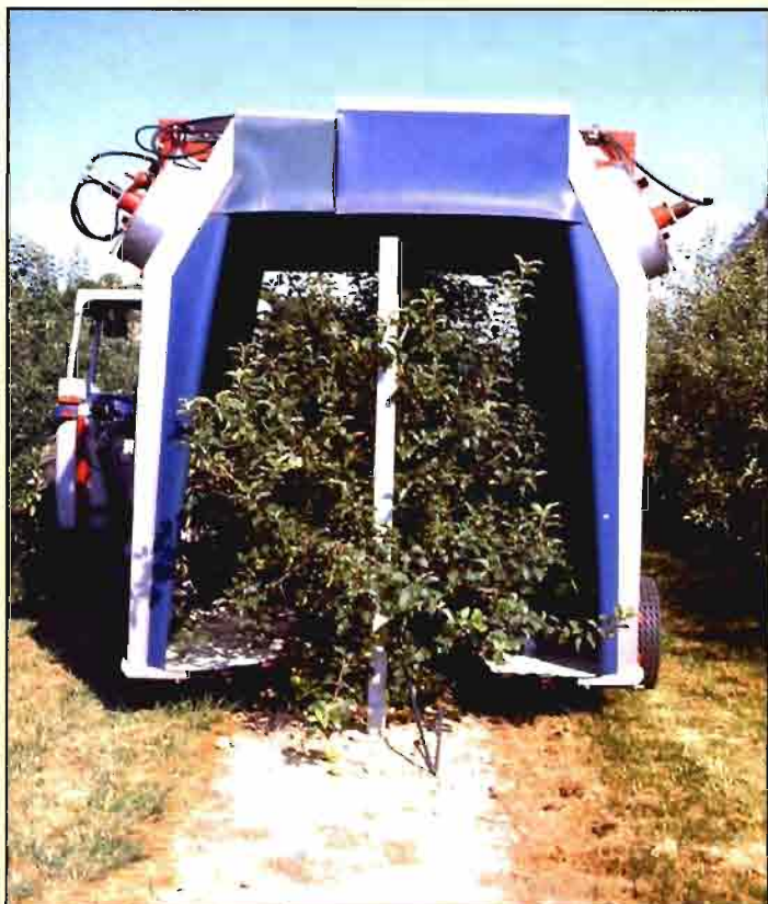
Túnel de reciclado para plantaciones frutales de bajo porte. El efecto deriva es, en este caso, eliminado por completo y, en consecuencia, la dosis fitosanitaria puede ser reducida.
