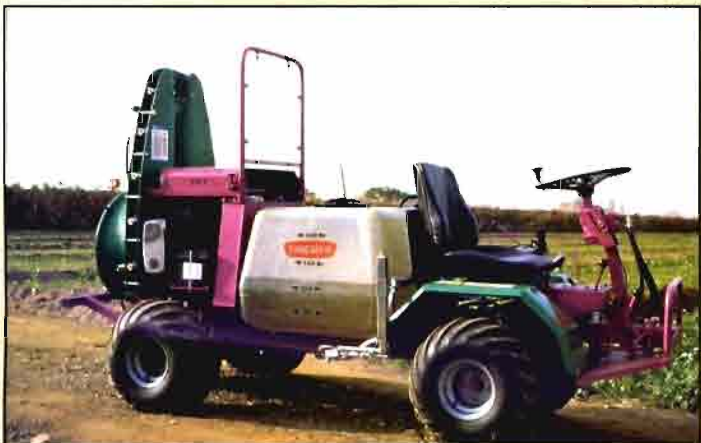
Pulverizador hidroneumático sobre vehículo autopropulsado, adaptado a cultivos de calles estrecho. Su empleo en invernadero permite una mejor cobertura del cultivo y mayor protección del aplicador.
