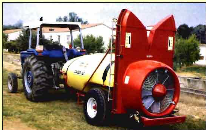
Sistema de deflectores verticales para el tratamiento de plantaciones intensivas posibilitando una notable reducción de la deriva.
