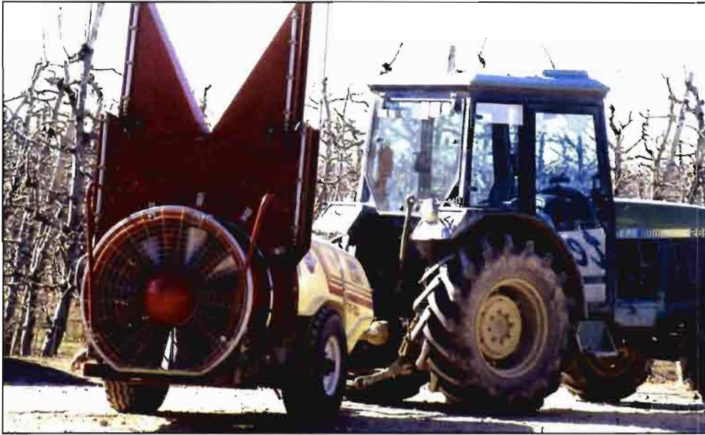
Figura 4. Pulverizador para plantaciones intensivas equipado con deflectores tangenciales. La dirección del flujo de aire limita la formación de deriva.
