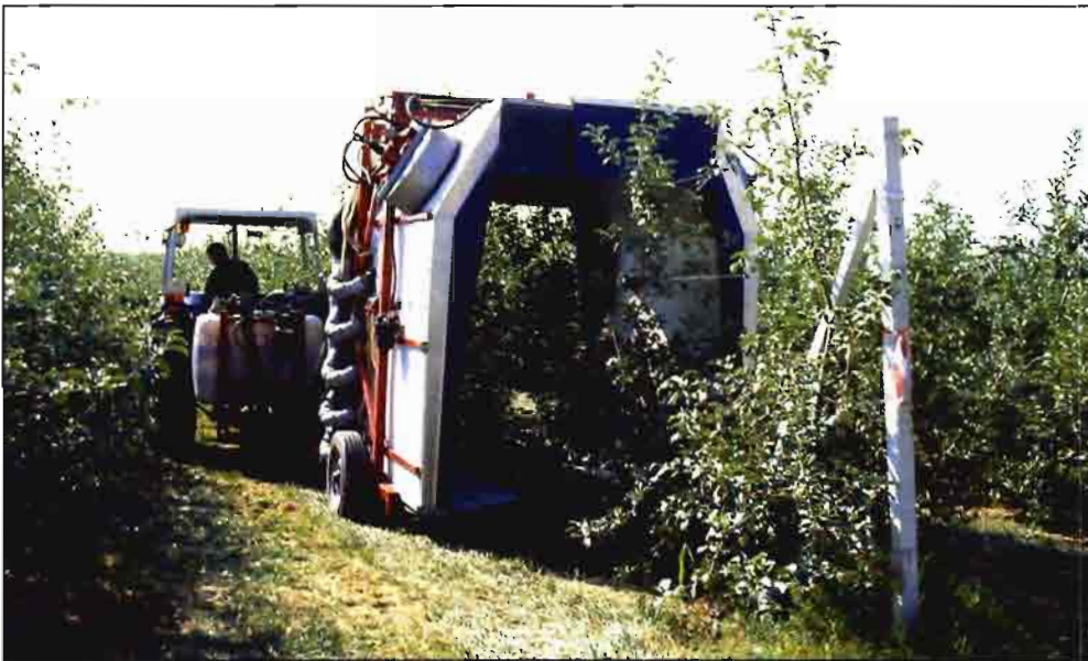
Figura 5. Túnel de pulverización para viñedo en espaldera. Permite operar simultáneamente sobre dos filas y eliminar casi por completo el efecto deriva (Centro de Mecanización Agraria).
