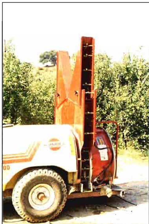
Fig. 4. Pulverizador hidroneumático con deflectores para proporcionar una mayor capacidad de penetración y reducción de pérdidas.
