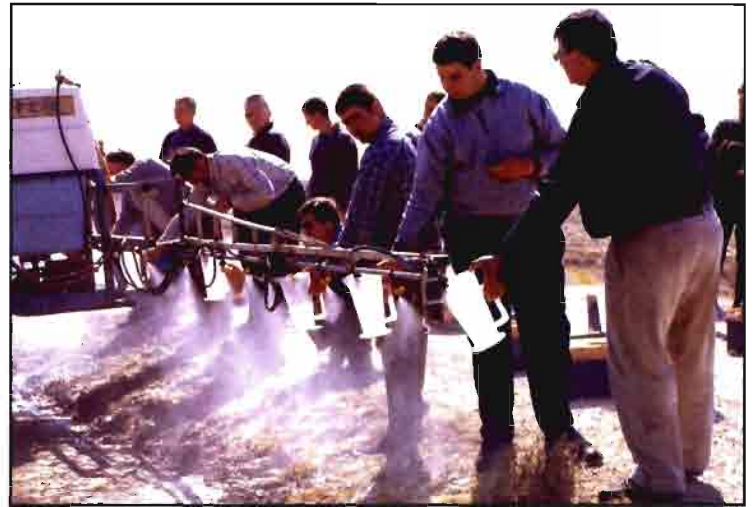
Medida del caudal de boquillas para la determinación de la uniformidad de distribución.
