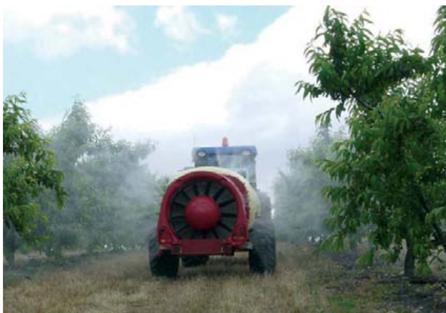
Foto 1. Aplicación de productos fitosanitarios por pulverización hidroneumática en cultivos arbóreos. Foto: Ferran Camp.
