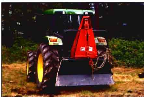
F.7. Cabrestante accionado por la toma de fuerza de un tractor.
