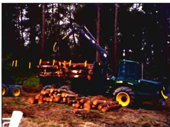
F.9. Autocargador Timberjack 1110, de 155 CV.
