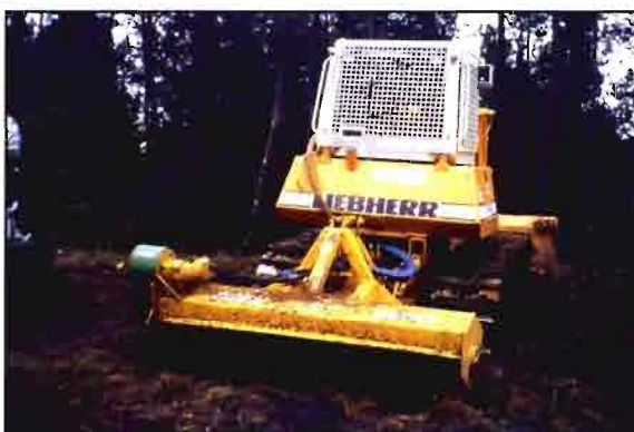
F.12. Desbrozadora Serrat, con ancho de trabajo de 1,60 a 2,30 m.
