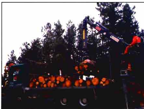
F.10. Carga de madera al camión con grúa propia.
