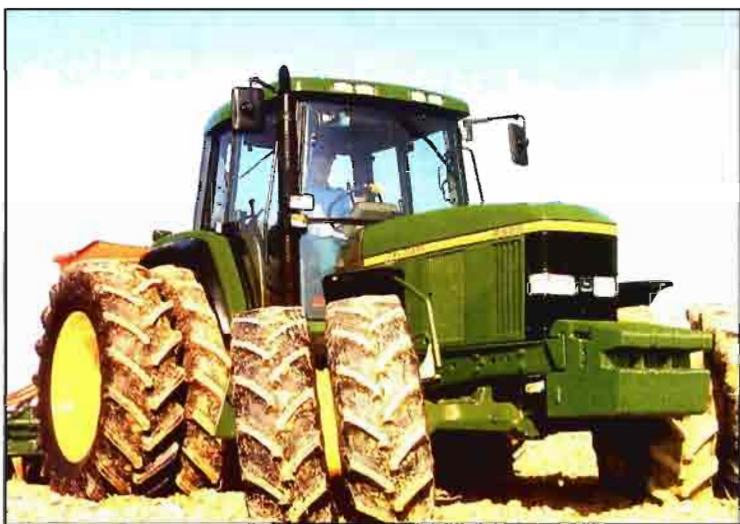
Fig. 5. Gemelado de ruedas delanteras y traseras.
