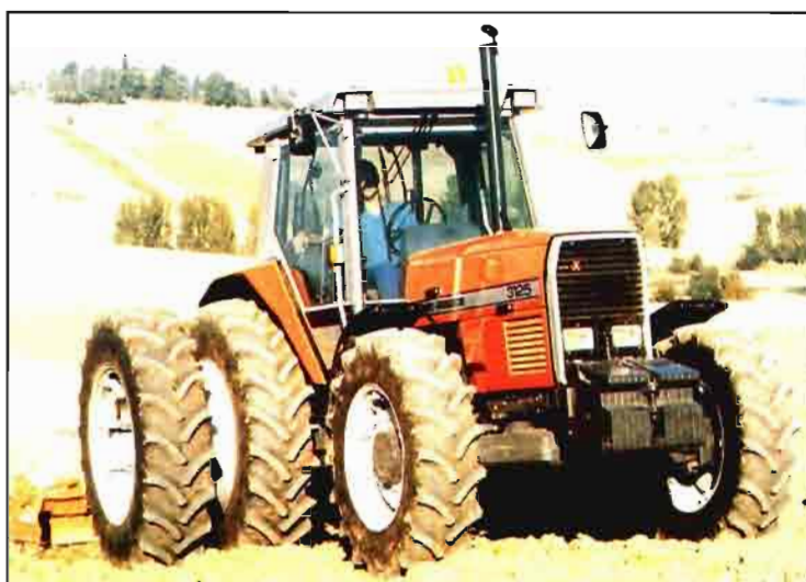
Fig. 4. El gemelado de ruedas puede ser interesante en las labores de siembra.
