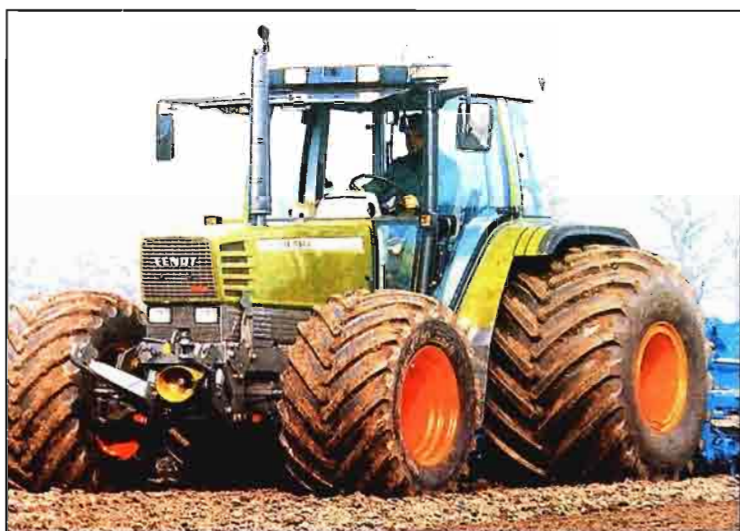
Fig. 3. Los neumáticos de baja presión toleran una presión de inflado inferior.
