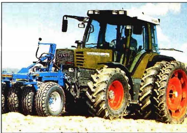
Fig. 6. Rodillos portantes acoplados al elevador hidráulico delantero.
