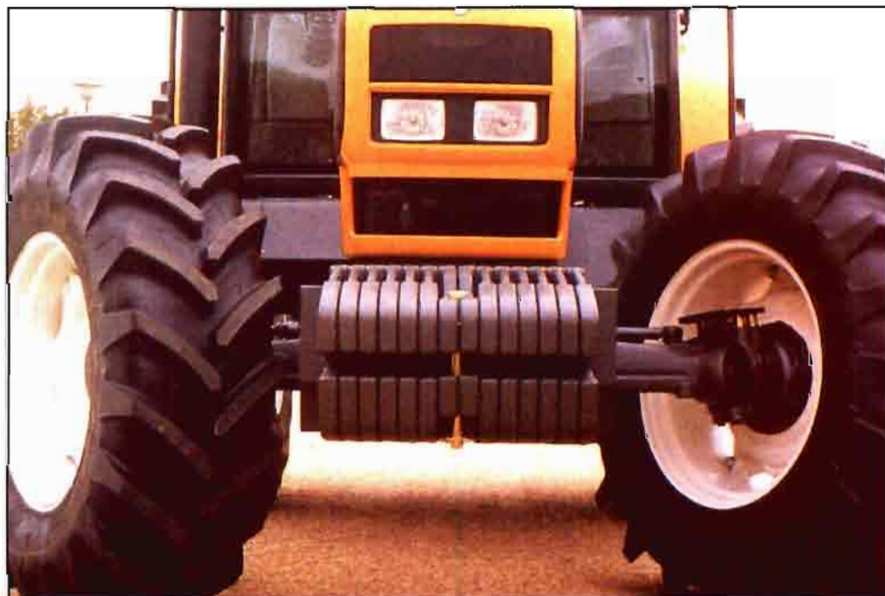
Fig. 1. Los tractores agrícolas suelen montar neumáticos radiales
