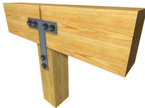
Figura 11. 3D e imágenes tipo de de encuentros de pilares vigas y viguetas
