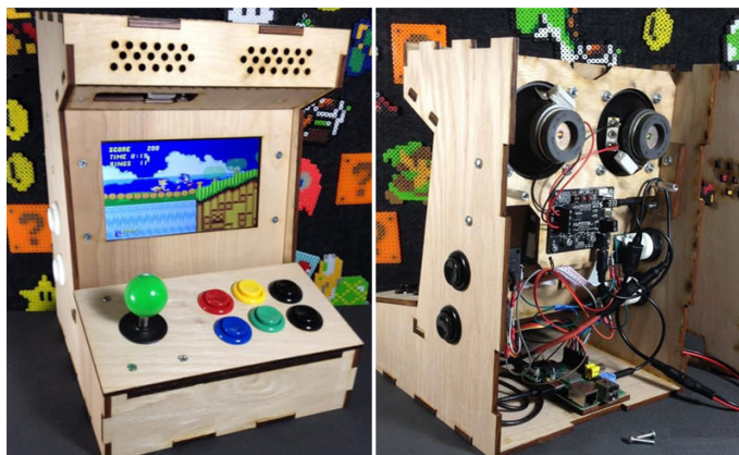
Figura 12: Consola arcade realitzada amb la Raspberry Pi
