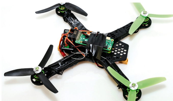
Figura 13: Dron amb una Raspberry Pi de controladora
