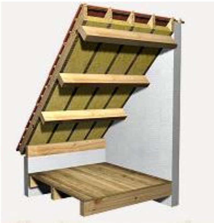
Il·lustració 40: Detall rehabilitació interior d'una coberta inclinada
