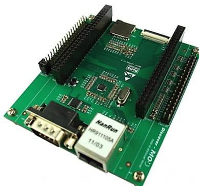
*Figura 59: Placa de Expansion para STM32*
