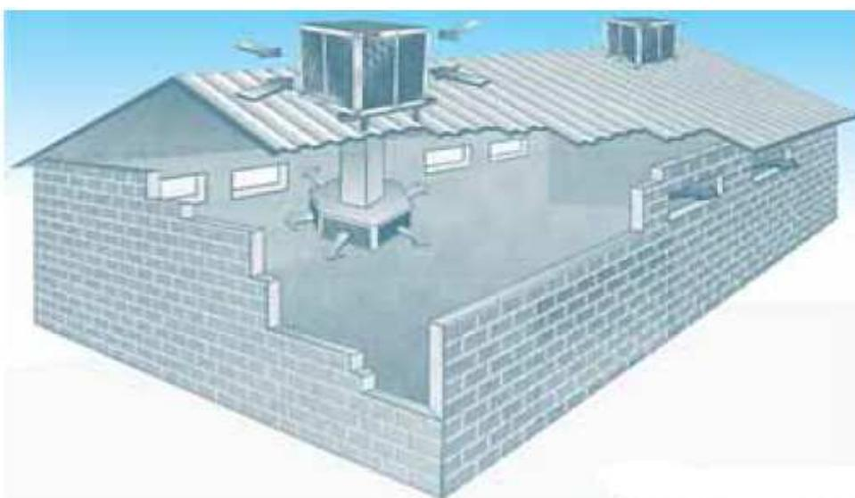
**Imagen 29. Ventilación por sobrepresión. Instalación en cubierta.**
