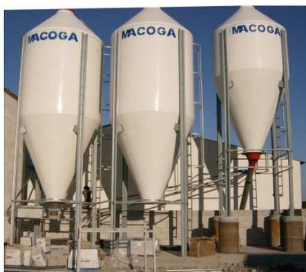
Imagen 65. Silos de PVC reforzados con fibra de vidrio.
