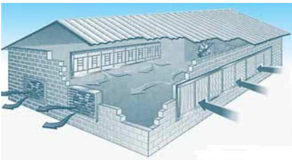
**Imagen 26. Ventilación por depresión. Túnel doble.**
