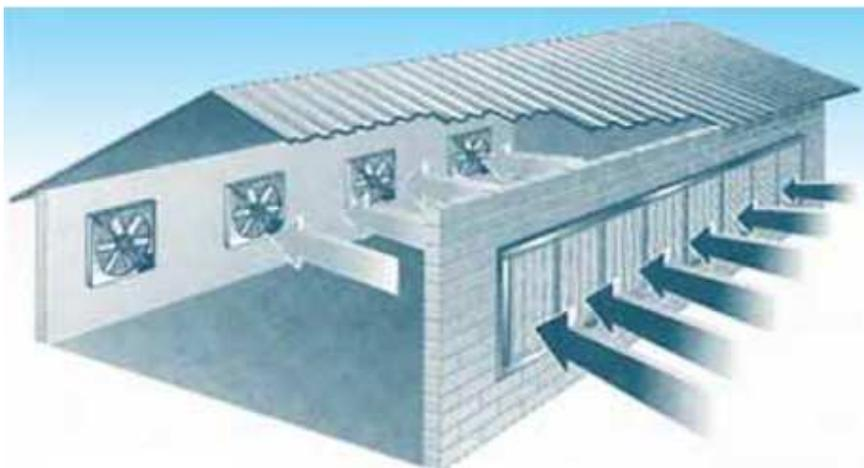
**Imagen 25. Ventilación por depresión. Instalación transversal.**
