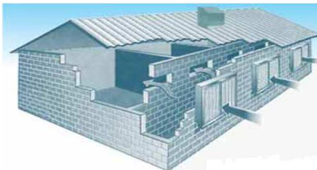
**Imagen 27. Ventilación por depresión. Instalación transversal por pasillo.**
