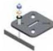
Imagen 4. Perno de anclaje de la jaula.
