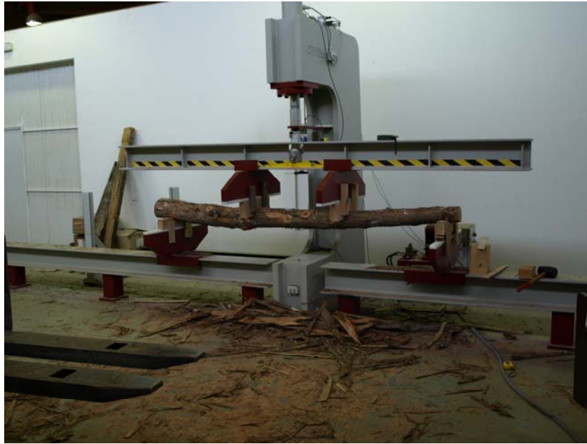
Foto 6: Ensayo mecánico a flexión
