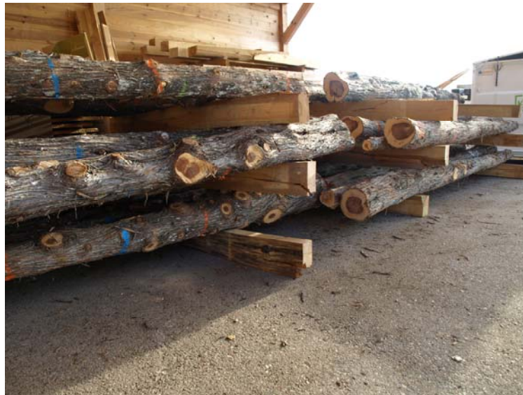
Foto 3: Material de ensayo rastrelado para su secado y acondicionado.
