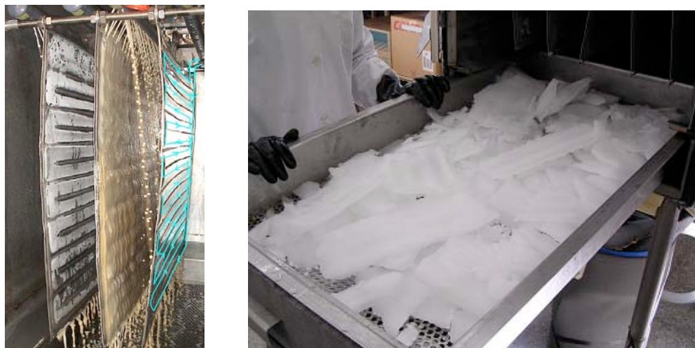
Figura 1.13. Interior d'un sistema de crioconcentració de plaques. A l'esquerra, circulació del refrigerant i la solució a concentrar. A la dreta, recollida del gel format a la safata de la base.
