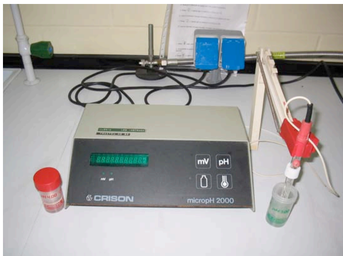
Figura 4.4. Calibrat del pHmetre Crison microH 2000, prèviament a la mesura.
