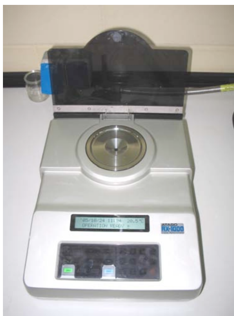
Figura 4.3. Mesura del contingut en sòlids solubles. Refractòmetre Atago RX-1000.
